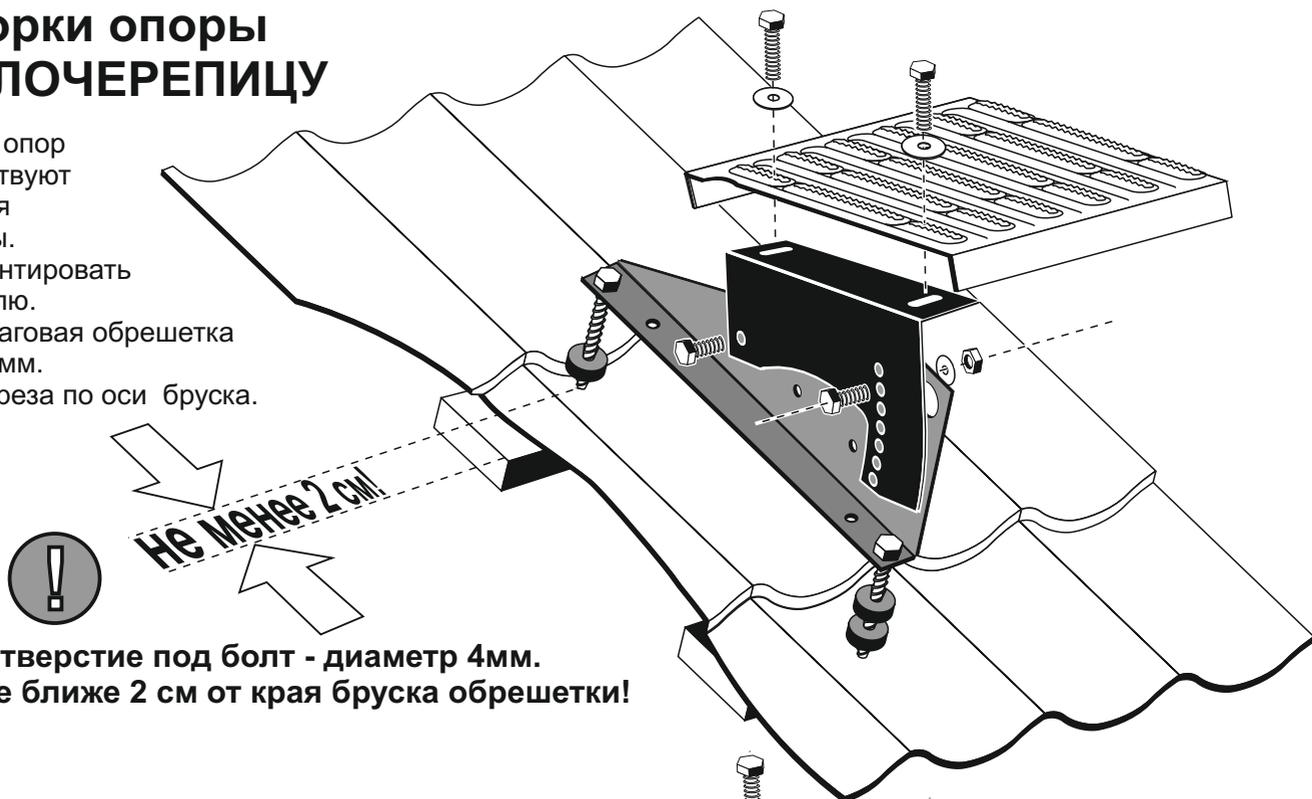
Отверстие под болт - диаметр 4мм.
